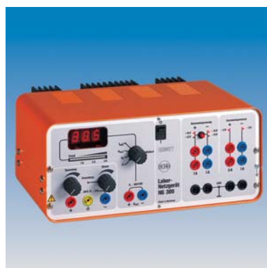
UNIWATT NG 309 – Laboratorní zdroj konstantního napětí vícenásobný
