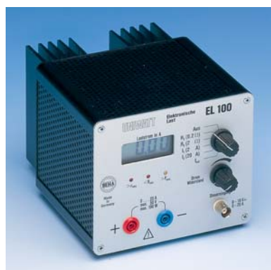
Přístroj UNIWATT EL 100. Vstupní výkon 100 W
