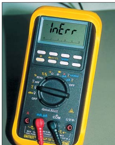
Chybné zapojení je signalizováno na displeji
