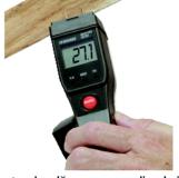
HHMM690 je jednoduchý měřič vlhkosti dřeva. Jednoduše zapíchněte měřicí hroty do dřeva a na displeji odečtěte jeho vlhkost (měřicí rozsah 8 až 28%). Tři barevné odstíny indikují obsah vlhkosti dřeva: Zelený: vzdušná vlhkost, Žlutý: mírně nad normálem, Červený: vysoká vlhkost. Přístroj HHMM690 pracuje na principu měření elektrického odporu.
